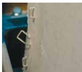
Test allo Shake Table. Le graffe fuoriescono dopo esser state sottoposte a Petrovac.
